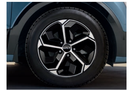
Jante alliage 16", Type A. 6,5J x 16, adaptée aux pneus 205/60 R16. La jante est livrée avec un cache et cinq écrous. ATF40AK000 (bicolore, HEV/PHEV)
