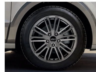
Jante alliage 17", Osan. 7,0J x 17, adaptée aux pneus 215/55 R17. Cache inclus, possibilité d'utiliser les écrous d'origine. P2400ADE07NGR (graphite, EV)
