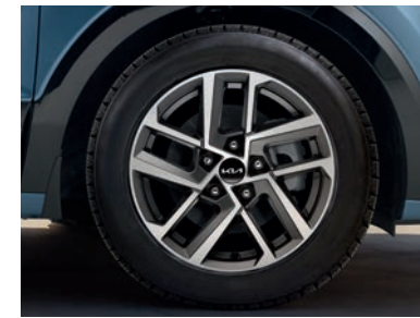
Jante alliage 16", Gaya. 6,5J x 16, adaptée aux pneus 205/60 R16. Cache inclus, possibilité d'utiliser les écrous d'origine. AT400ADE06BC (bicolore, HEV/PHEV)
