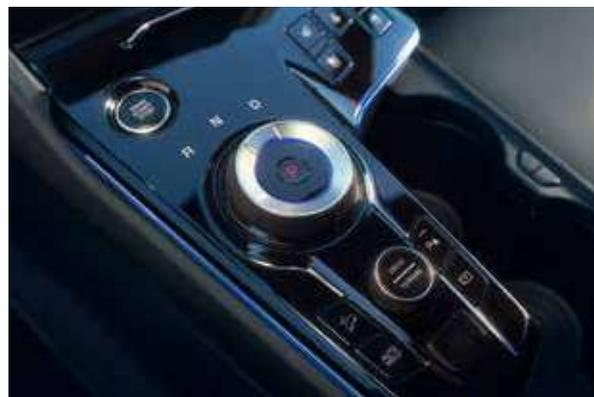
**Sélecteur de rapport rotatif.** Situé au centre et à portée de main, le sélecteur rotatif fonctionne à l'aide de la technologie shift-by-wire, permettant un passage des rapports sans effort (de série sur les versions DCT7/BVA6). Point tout aussi important en terme de sécurité : il sélectionnera automatiquement la position de stationnement P si le conducteur oublie de le faire.
