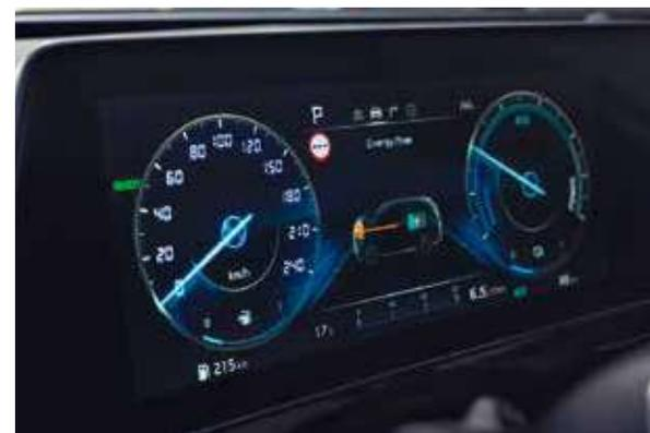
**Combiné d'instrumentation de 12,3" avec écran ultra-large.** Doté d'un affichage LCD TFT de dernière génération caractérisé par des graphismes d'une netteté et d'une précision exceptionnelles. L'interface du combiné d'instrumentation peut être personnalisée en fonction du mode de conduite choisi par le conducteur.
