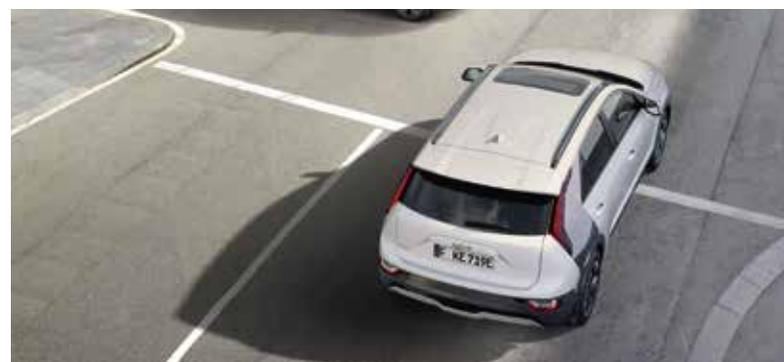
**Freinage d'urgence autonome (FCA 2) du Niro EV 100% électrique - avec fonctions intersection et croisement.** Le système FCA 2 fait appel à une caméra avant et à des capteurs pour détecter tout véhicule, piéton ou cycliste en amont. En émettant un signal d'alerte et en activant les freins automatiquement, il vous permet d'éviter une collision ou d'en réduire la gravité. Ce système est également opérationnel lorsque vous traversez ou tournez à une intersection<sup>(1)</sup>.
