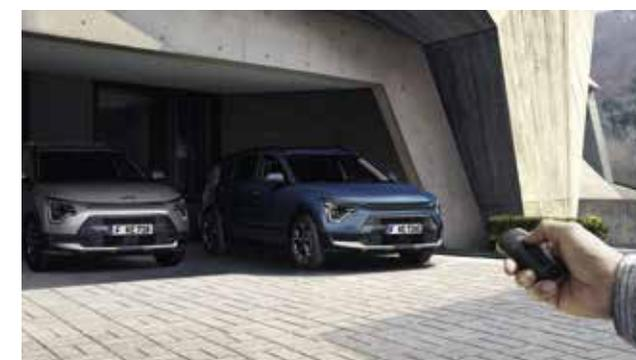
**Assistance au stationnement à distance (RSPA).** Grâce à ce système, vous pouvez stationner votre Kia Niro et lui faire quitter une place de stationnement même sans être au volant - la solution idéale en espaces restreints. Il vous suffit d'utiliser la clé pour déplacer le Niro en ligne droite en toute sécurité, que ce soit pour le faire entrer ou sortir d'une place de stationnement. Le véhicule freine automatiquement dès qu'il détecte un obstacle<sup>(1)</sup>.
