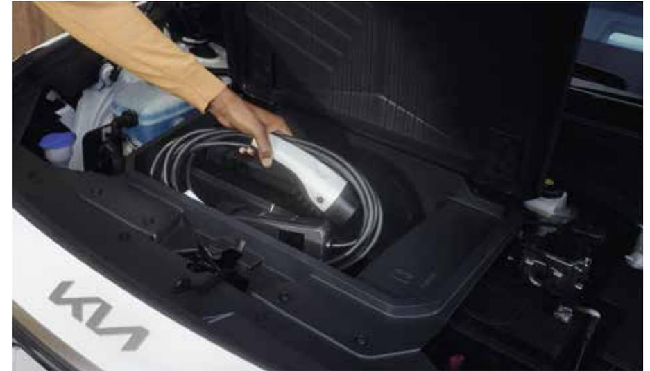
**Coffre avant.** À l'avant, le Niro EV 100 % électrique dispose d'un coffre de rangement sous son capot. Offrant un volume de 20 litres, il s'avère idéal pour ranger toutes sortes d'objets dont le câble de charge et l'adaptateur V2L (recharge bi-directionnelle Vehicle-to-Load, fonctionnalité et adaptateur disponibles en option uniquement).
